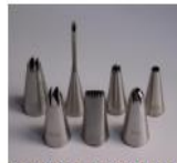
boquillas sin soldaduras
